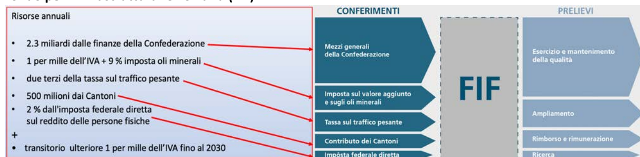
Fig. 4: Il meccanismo di finanziamento dell'infrastruttura ferroviaria svizzera (FIF)
